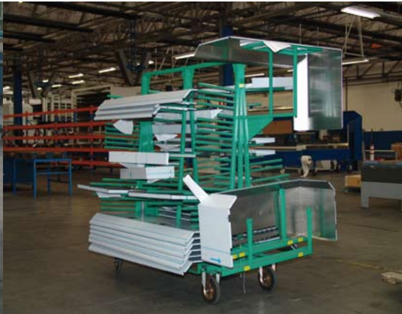
Bij de nieuwe bevoorrading bij Moba is de pull-methode toegepast. De nieuwe kar is ontwikkeld door medewerkers van de leverende en de ontvangende afdeling.
