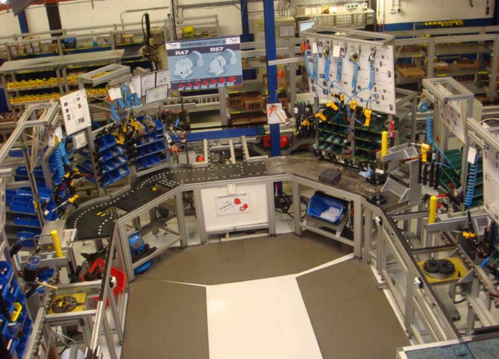
Werkeiland bij Vector Aandrijftechniek in Rotterdam, door de medewerkers zelf gemaakt. Doorloop- en productietijden halveerden na invoering van deze werkeilanden.
